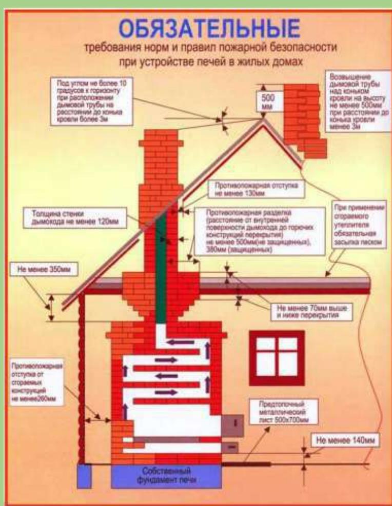
должны иметь утолщения кирпичной кладки - распушку. Не нужно забывать и про утолщение стенок печи. Длястыковки массива печи с деревянными перегородками применяется противопожарная разделка.
